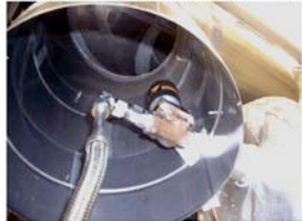
窒素ガス排気口と電磁弁 レバーロック低温カプラ（液体窒素用）（水道用電磁弁：使用時間6年）
