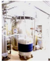
液体ヘリウム 3000L容器 汲み出し システム 容器の蒸発量 4~5L/Day 汲み出し用 リフトが無い
