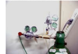
1本のボンベから複数の圧力調整器 2次側圧力の変動が起こり難い
