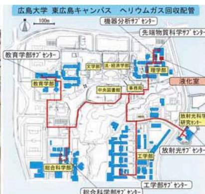
ヘリウムガス回収配管
