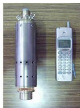
汲み上げポンプ
